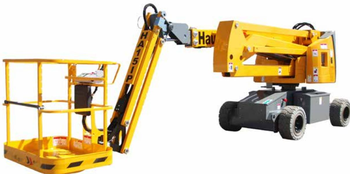
La piattaforma semovente articolata da 15 mt, è ideale per grandi costruzioni e lavori di rifinitura, manutenzione e pulizia spazi verdi, logistica, distribuzione e industria, manutenzioni o ristrutturazioni. Altezza a riposo 2mt che permette il passaggio sotto porte standard. Grande autonomia di lavoro con comandi proporzionali.
