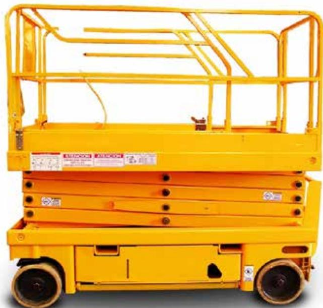
La piattaforma a pantografo da 12 mt, grazie alle dimensioni ridotte, è l'attrezzatura ideale per qualsiasi applicazione in diversi campi: edilizia, imprese di pulizia, eventi fieristici... Compatta e maneggevole può essere impiegata in spazi ristretti. Grazie all'alimentazione a batterie questa piattaforma è molto silenziosa e per questo adatta a lavori in contesti residenziali. Portata massima 450 Kg.
