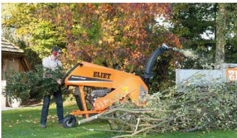
Biotrituratore dal motore compatto, facile da utilizzare con una grande capacità di taglio, adatto a ogni necessità di taglio in giardino. Macchina semovente: grazie al suo design compatto si presta ad essere manovrata con facilità anche in spazi non molto ampi. La macchina è adatta a rami dello spessore massimo di 120 mm.
