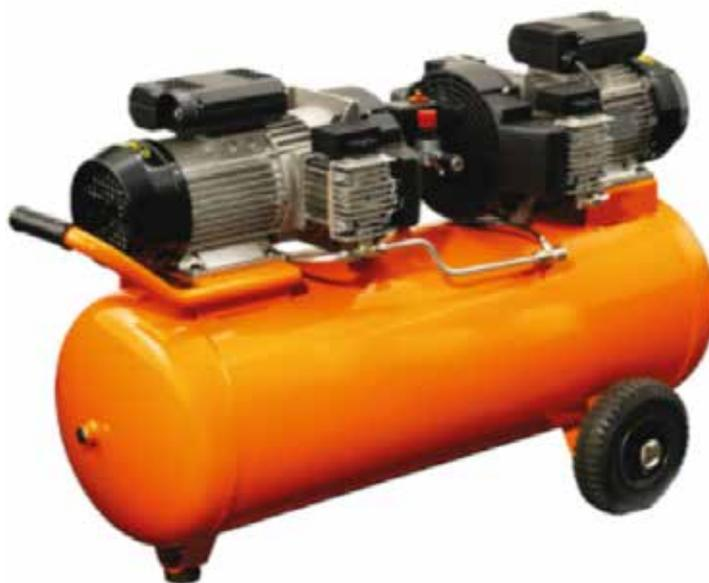
Adatto per verniciare, scalpellare, sturare, sabbiare, gonfiare, levigare. Utilizzabile con demolitori con alta portata d'aria. Dotato di due motori. Serbatoio da 90 lt. Ruote in gomma piena. Classe di lavoro S1, adatto all'utilizzo in continuo (24h) elimina gli stop termici. Spunto a bassi voltaggi (185V) con cavi elettrici di lungo raggio. Funzionamento garantito anche sotto lo zero termico.
