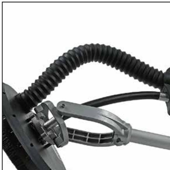
Sviluppata appositamente per effettuare lavori di carteggiatura su muratura, cartongesso rimozione di pitture e preparazione delle superfici.
