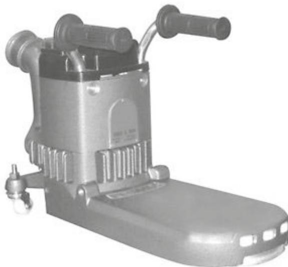
Macchina concepita per ottenere levigature professionali su ogni superficie in legno. Equipaggiato con un potente motore da 1.250W, ha un braccio lungo 300 mm, ideale per ottenere levigature professionali su ogni tipo di superficie in parquet, in special modo sotto i radiatori. Può lavorare con sacco polvere standard, sacchetti di carta monouso e aspiratore remoto.
