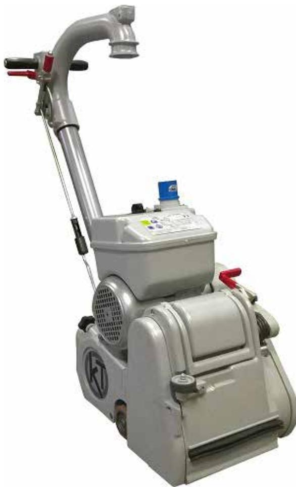
La macchina, dal peso di soli 60 kg, è disponibile nella versione a 2,2 kW. La velocità di smontaggio in tre parti (basamento, motore e manico) per un trasporto più agevole da parte di un solo operatore. Può lavorare con sacco polvere standard, sacchetti di carta monouso. È la smerigliatrice ideale per tutti i professionisti e per il mondo del noleggio, per un uso professionale su tutti tipi di parquet.
