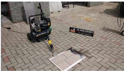
Sollevatore e demolitore piastrelle alimentato ad aria compressa. Attrezzo verticale che consente di operare in piedi senza piegare la schiena. Ideale per chi deve staccare ampie superfici pavimentate.
