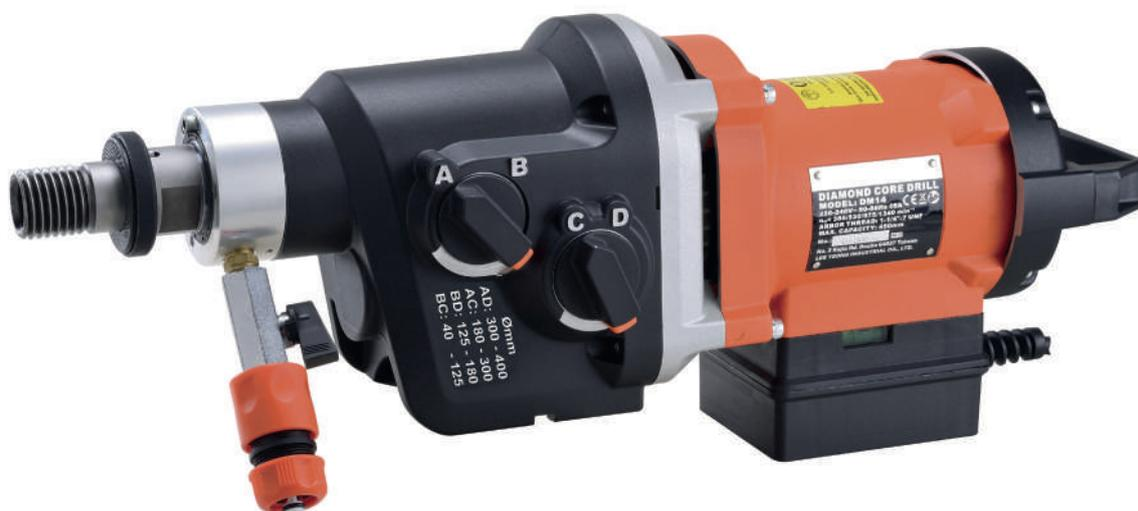
Carotatrice per cotto e cemento armato a umido. Per essere utilizzata deve essere montata sul cavalletto di supporto apposito. Può montare foretti con  $\varnothing$  minimo di 40mm e fino ad un  $\varnothing$  massimo di 450 mm.
