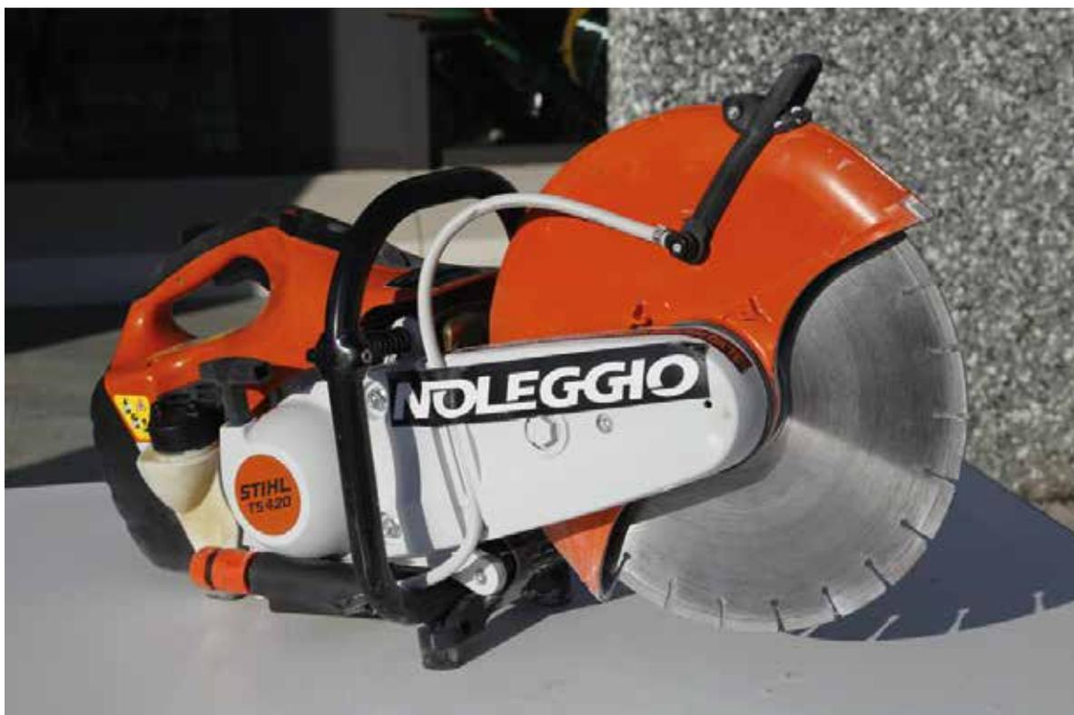
Troncatrice di uso universale per costruzioni sopra e sotto terra. Adatta per asfalto, calcestruzzo, calcestruzzo abrasivo, cordoli in cemento armato, cordonate, tegole di terracotta, pietra, tubi di ghisa, acciaio (esclusi binari ferroviari). Con disco da taglio di 35 cm per una profondità di taglio fino a 12,5 cm. Il sistema antivibrante STIHL permette di guidare bene la troncatrice nel taglio. Filtro aria di lunga durata, avviamento poco faticoso grazie alla valvola di decompressione.
