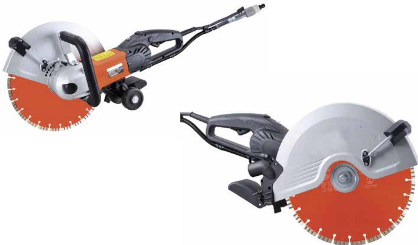
La troncatrice a mano ad acqua e a secco è adatta per cemento, muratura e pietra. È progettata per il taglio a umido, ma è anche perfettamente adatta per il taglio a secco on eventuale aspirazione. La lega di magnesio è utilizzata per la protezione della lama, la piastra del cambio e scatola ingranaggi per la massima resistenza e peso minimo.
